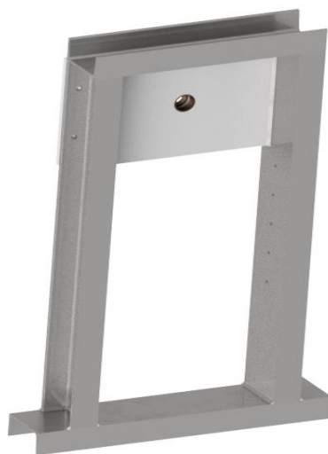
4.1-сурет – Кривошипті пресстің жоғарғы бөлігінің 3D моделінің конструкциясы
