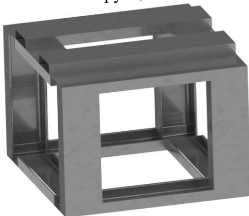
4.2-сурет – Пресс негізінің конструкциясы
