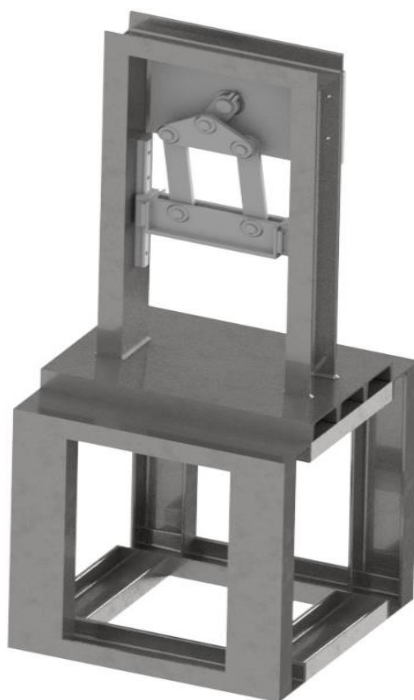
4.6-сурет – Autodesk Inventor жүйесіндегі жасалған кривошипті пресс механизмінің бүкіл конструкциясы
